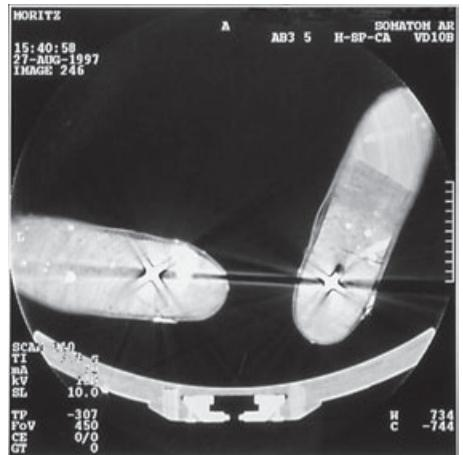
Abb. 12: Dieser virtuelle Schnitt durch die Füße der Figurine zeigt den Bruch im Mittelfußbereich (im Bild rechts) sowie die Lage der großen schmiedeisenen Nägel (kreuzartige Überstrahlungen in der Aufnahme)
